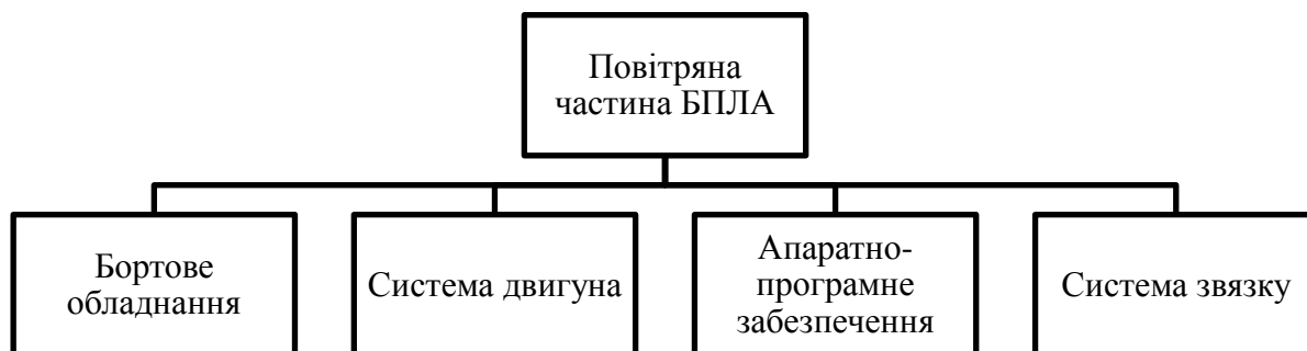
Рисунок 1.12 Схема складових частин повітряної частини БПЛА. Джерело: [34]
